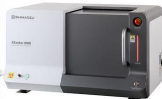
卓上 X 線 CT システム XSeeker 8000 試料サイズ \phi 50~ \phi 300, H320mm, 重量10kgf以内 推奨サイズ \phi 100, H80mm
